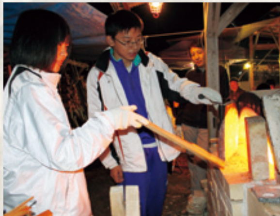
▲「希望の窯での焼成」 10月に行われた陶芸作品の焼成。朝8時ごろから翌日の昼ごろまで、ゆっくり温度を上げ、未明から1200度以上の温度を保つよう、交代で次々と薪を入れる。
